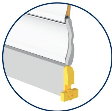
Auch die **stranggepresste Aluminium-Schlussleiste** ist pulverbeschichtet und farblich passend zu den Führungsschienen. Durch seitlich angebrachte **drehbare Anschläge** wird die Optik nicht durch Stopper oder Winkelendleiste beeinträchtigt, da diese unsichtbar in der Führungsschiene laufen. Im Revisionsfall lässt sich der Rollladenpanzer einfach komplett in den Kasten ziehen.
